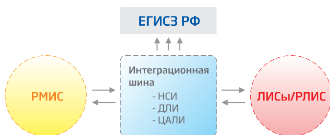
Схема 2. Реализация региональной подсистемы ЛИ с использованием интеграционной шины, ЛИСов/РЛИС и единой системы РМИС.
